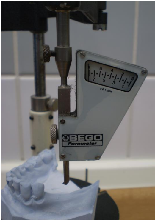
indikátor podsekřivin s číselnou stupnicí usnadňuje rozbor modelu
